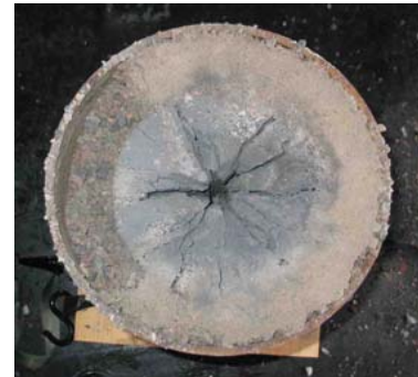
Sprängning mot kompakterat rasberg
